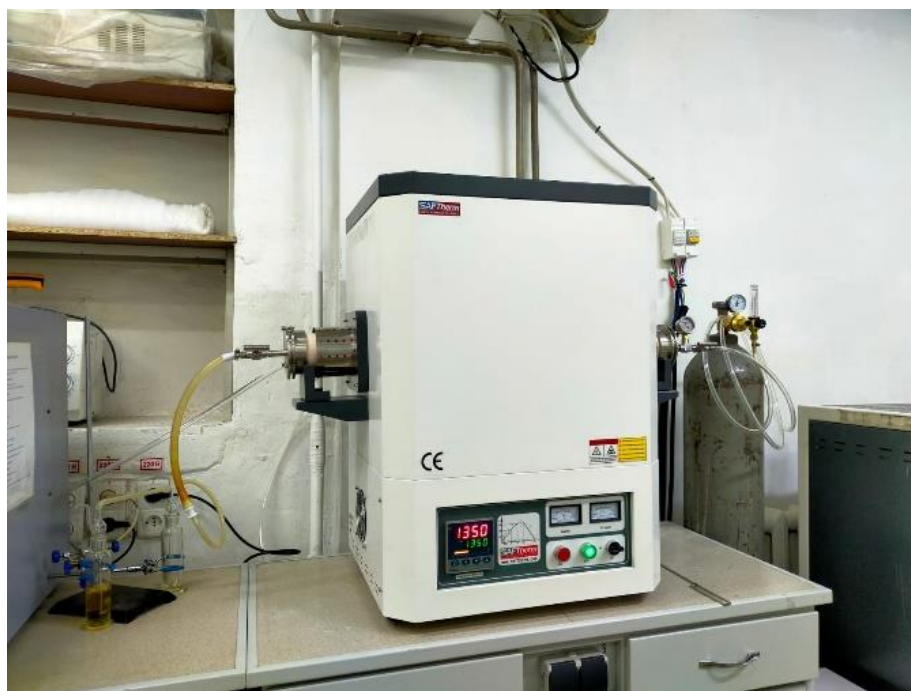
Сурет 1. МАХ фазасын синтездеуге арналған жоғары температуралы құбырлы вакуумдық пеш
